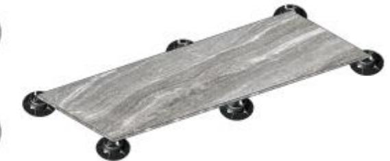
сли пол предназначен для общественных мест или при наличии больших нагрузок Florim предписывает установить дополнительные опоры под плитой в соответствии с указанной ниже схемой
