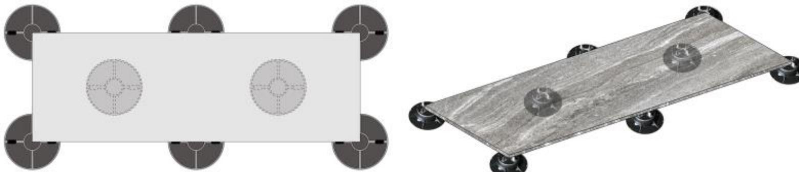
В случае если потребуется возвышение более 10 см, Florim предусматривает наклеивание предохранительной пластины или сетки и дополнительные опорные элементы под плитой, как показано на нижеследующей схеме.
