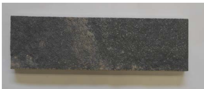
Figura 1. Campioni di Sezione 290 x 86 x 20 mm utilizzati per la prova (Rif. 2-c)
