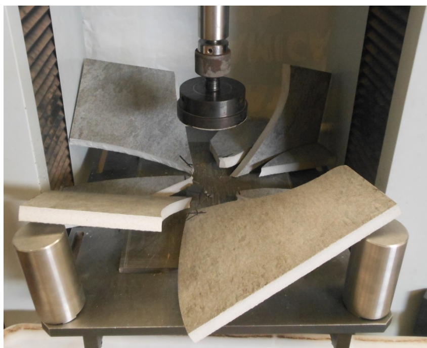
Figura 4. Immagine del campione dopo rottura (Rif. 2-c)
