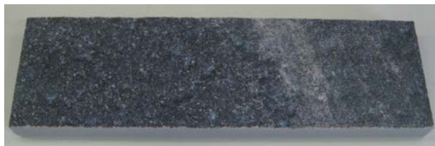
Figura 1. Campioni di Sezione 290 x 86 x 20 mm utilizzati per le prove (Rif. 2-c).
