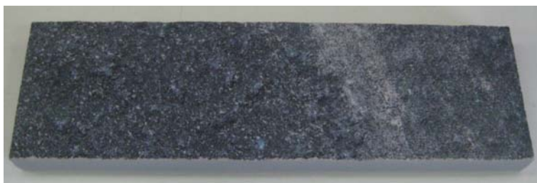
Figura 1. Campioni di Sezione 290 x 86 x 20 mm utilizzati per la prova (Rif. 2-c)
