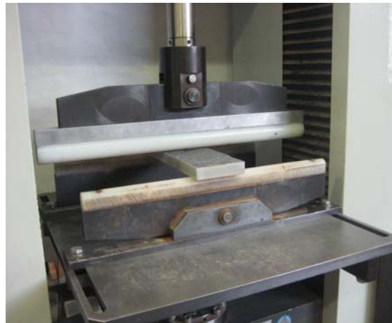
Figura 3. Attrezzatura per la Determinazione della Resistenza a Flessione
