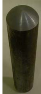
Figura 3. Penetratore utilizzato per la prova (Rif. 2-d)
