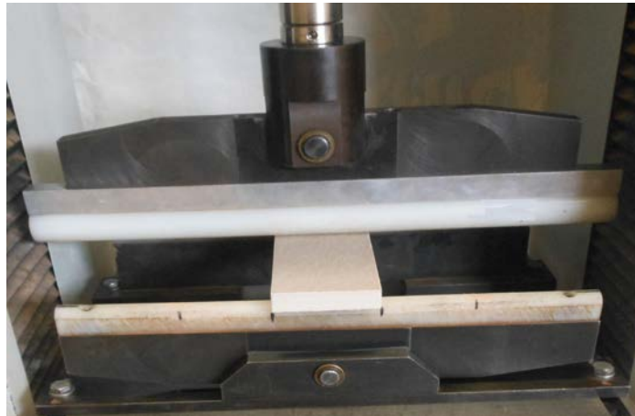
Figura 3. Attrezzatura per la Determinazione della Resistenza a Flessione.
