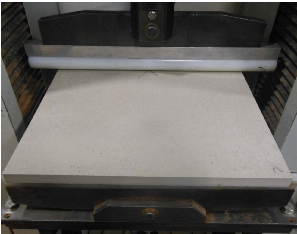
Figura 3. Attrezzatura per la determinazione della resistenza a flessione.
