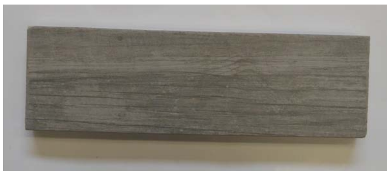
Figura 1. Campioni di Sezione 290 x 86 x 20 mm utilizzati per le prove (Rif. 2-c).
