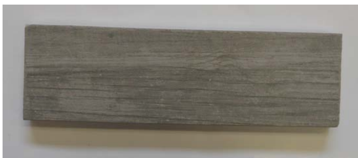
Figura 1. Campioni di Sezione 290 x 86 x 20 mm utilizzati per la prova (Rif. 2-c)
